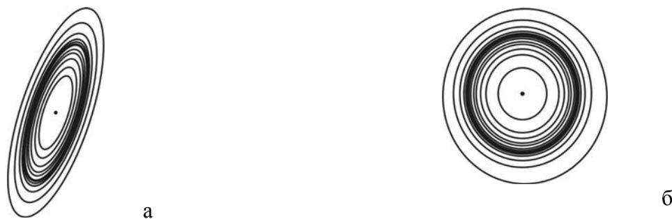
Рис. 5. Отображение состояния поляризации некогерентного света с эллиптической и круговой поляризациями.
