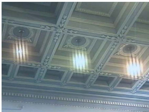
Рис.8. Наблюдение интерференционных полос Юнга различного контраста в дифракционных гало вокруг изображений осветительных ламп на потолке Большой физической аудитории, при рассматривании этих источников света через спеклограмму сдвига (слева лампа с видимой спиралью накаливания – малые размеры тела светимости, справа – 2 лампы с рассеивающей колбой).
