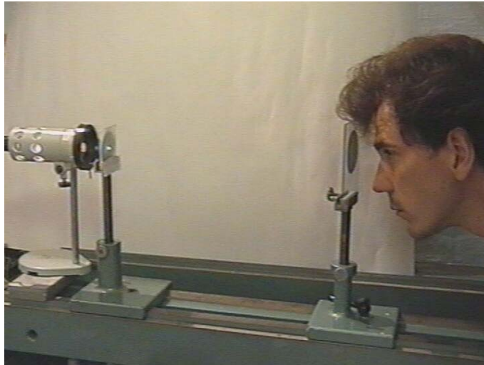
Рис.9. Изучение влияния степени пространственной когерентности излучения протяженного источника на видность интерференционных полос.
