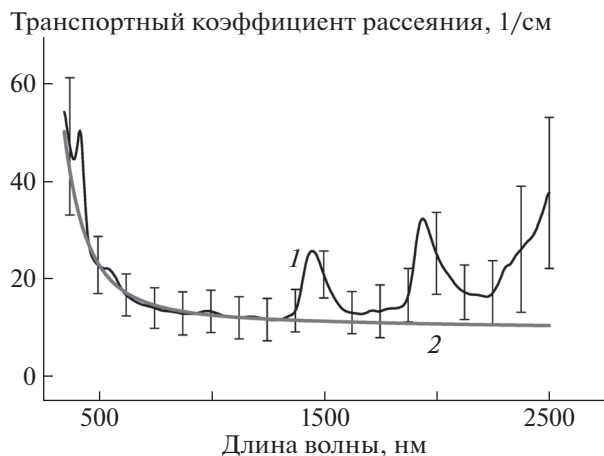
Рис. 4. Транспортный коэффициент рассеяния париетальной брюшины: 1 – экспериментальные данные, 2 – аппроксимация функцией \mu'_s(\lambda) = 3.539 \times 10^{10} \lambda^{-3.531} + 28.422 \lambda^{-0.124} .
